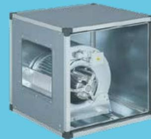
Unità di estrazione aria con ventilatore centrifugo con ventola a pale avanti a bassa rumorosità con motore direttamente accoppiato **monofase** o **trifase**. Esecuzione "V" La struttura portante è realizzata con profili estrusi in alluminio, chiusi da pannelli in lamiera zincata, rivestiti all'interno di **spugna fonoassorbente spessore 5mm, ignifuga cl.1**
