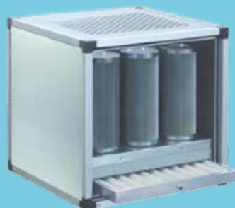
Le unità sono state progettate per un'azione filtrante e deodorizzante grazie alla presenza di filtri primari, dei filtri a tasche flosce e dei filtri a carbone attivo. La struttura portante è realizzata con profili estrusi in alluminio, chiusi da pannelli in lamiera zincata, rivestiti all'interno di spugna fonoassorbente spessore 5mm, ignifuga cl.1
